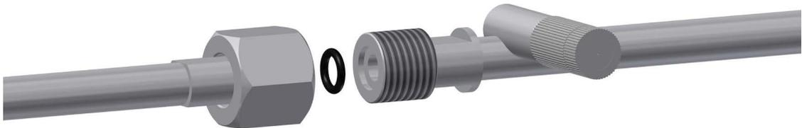
Fig. 28: Conexión de los tubos de las boquillas
