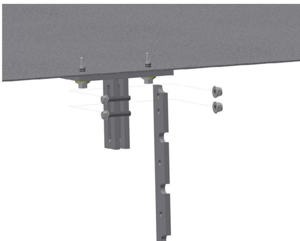
*Fig. 24: Fijación del elemento fijo de los tubos*
