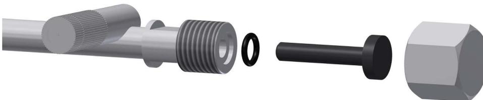
Fig. 29: Conexión de los extremos del tubo
